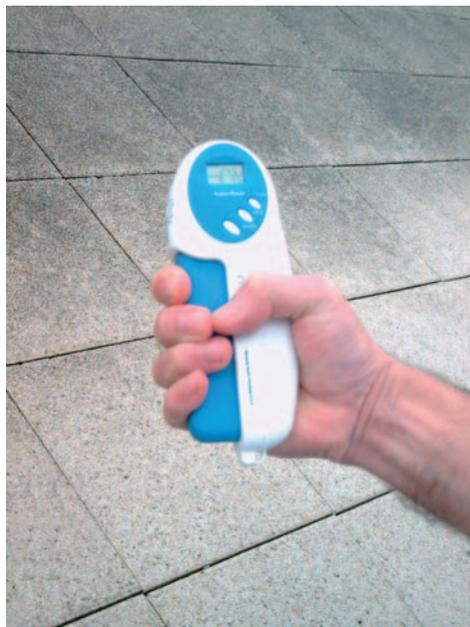
**Figure 8.** Dynamomètre utilisable par les non-voyants.
