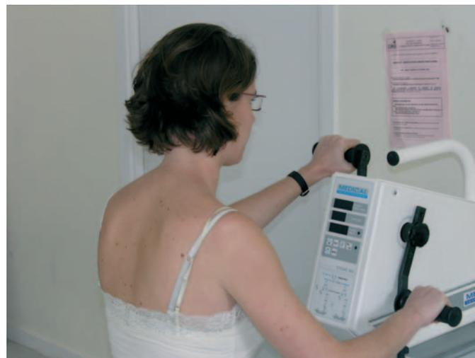
Figure 15. Cycloergomètre à bras. Les amputés des membres inférieurs sont testés en endurance sur cet appareil.
