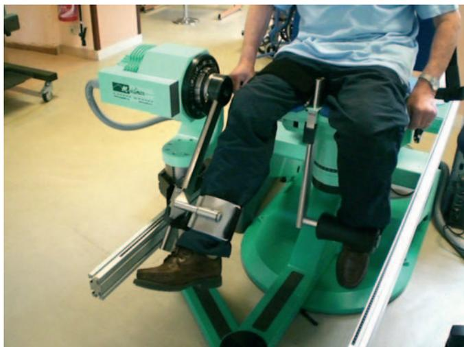
**Figure 11.** Dynamomètres isocinétiques rotatoires. Le dynamomètre teste les agonistes et antagonistes dans toute la course.
